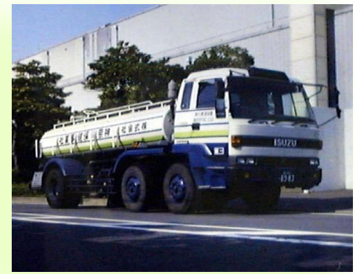
■バキューム車による地下排水槽の清掃
