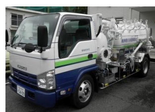
浄化槽清掃車両
